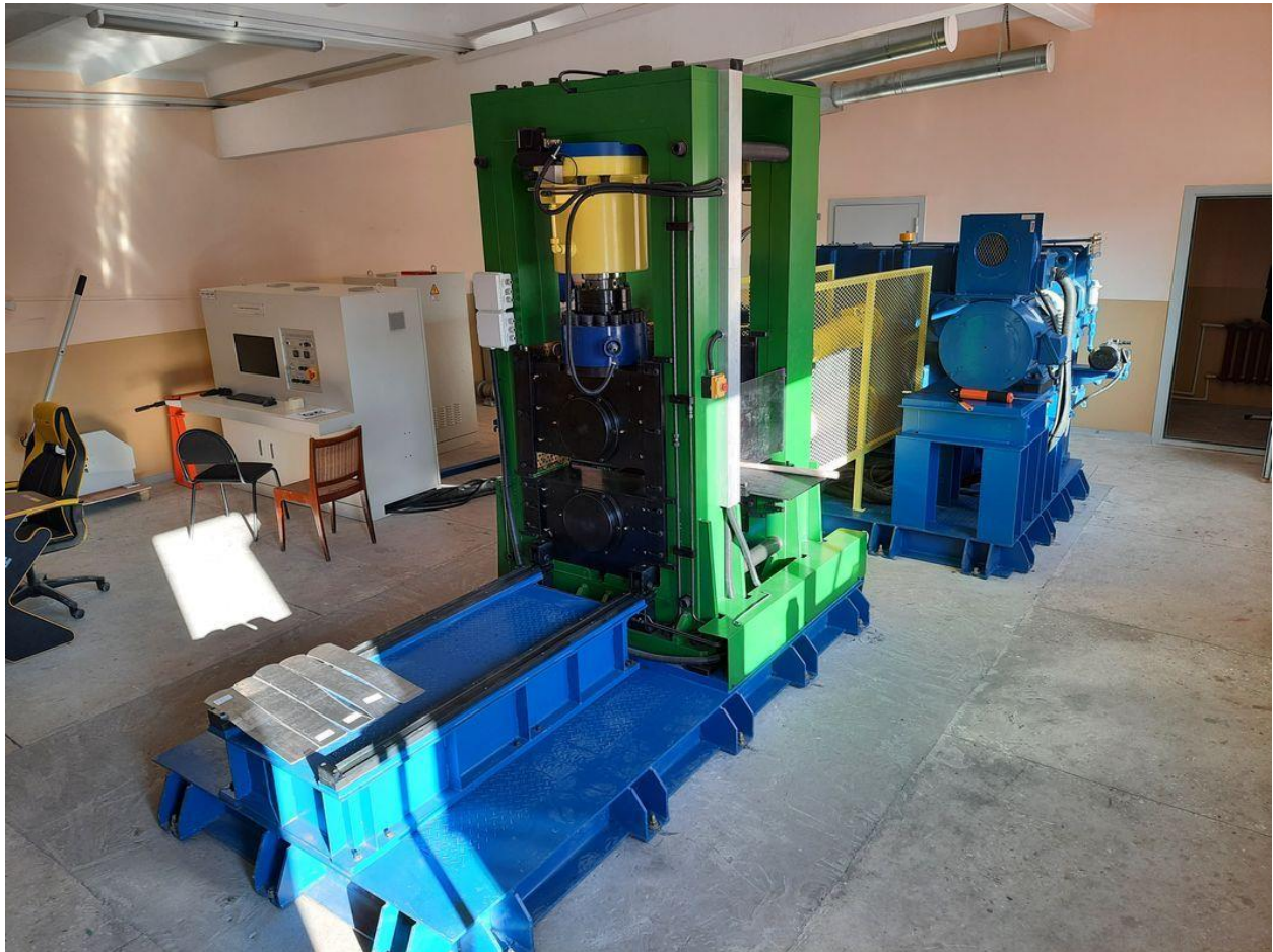
Рисунок 1. Общий вид конструкции опытно-экспериментального лабораторного стана дуо с индивидуальным приводом рабочих валков для реализации процессов асимметричной и аккумулярующей прокатки
