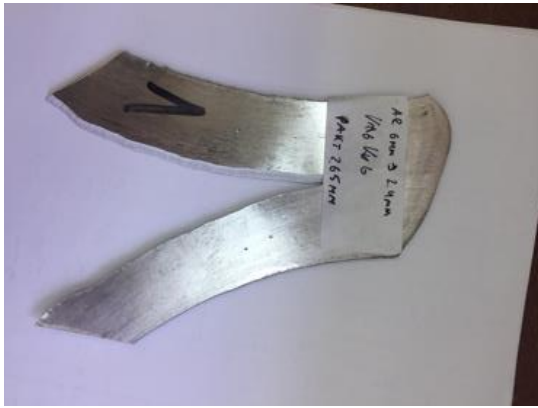
Рисунок 4. Вид разрушенного при симметричной прокатке образца
